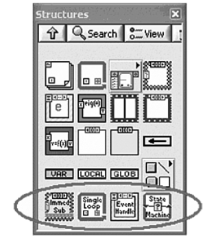
Рис. 8.17а. Настроенный вид палитры функций содержит иконки, представляющие четыре шаблона с одним циклом. Иконки настроены так, чтобы объединять соответствующий шаблон с выбранной блок-диаграммой
