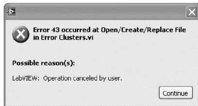
Рис. 7.7. ВП Simple Error Handler и ВП General Error Handler открывают диалоговое окно, отображающее код ошибки, источник и описание, которое пользователь должен изучить
